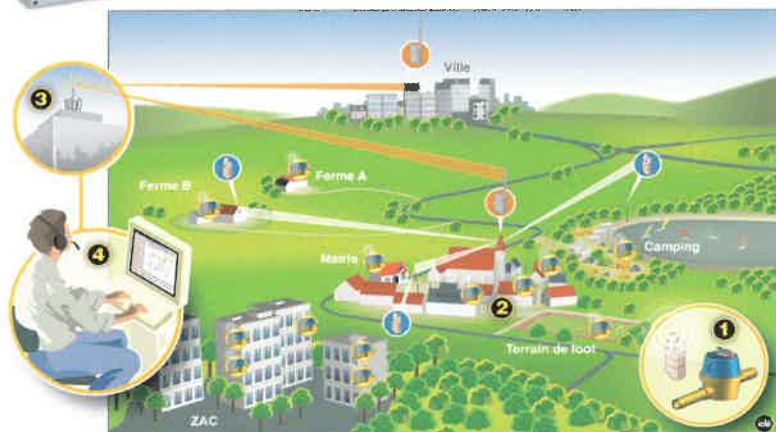
Concentrateur relayant les répéteurs au système centralisé
