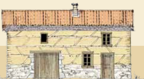
État initial d'une ferme en pisé.
