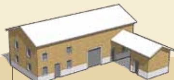
Ferme bloc en long de plus ou moins grande importance. L'habitation est prolongée par les bâtiments d'activités. La ferme peut évoluer sur un plan en L en recevant des extensions
