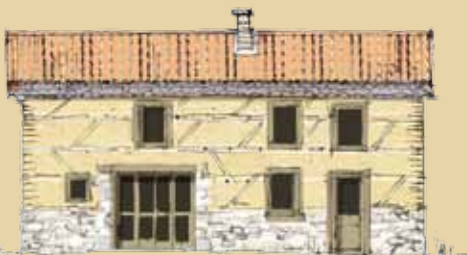
Proposition 1 : de nouveaux percements sont réalisés en respectant les proportions et le rythme de l'existant
