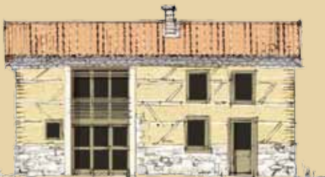
Proposition 2 : Des ouvertures verticales sur toute la hauteur du mur sont possibles, elles seront de préférence réalisées en continuité de l'existant. Des parties de mur en pisé très dégradées (fissure, ravine, effondrement) peuvent être également un endroit privilégié pour réaliser ce type d'intervention
